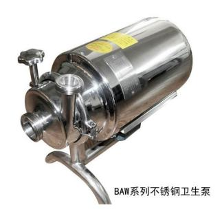
1、卫生级离心泵的选择及安装离心泵应该按照所输送的液体进行选择,并校核需要的性能,分析抽吸,排出条件,是间歇运行还是连续运行等。离心泵通常应在或接近制造厂家设计规定的压力和流量条件下运行。泵安装时应进行以下复查:①基础的尺寸,位置,标高应符合设计要求,地脚螺栓必须恰当和正确地固定在混凝土地基中,机器不应有缺件,损坏或锈蚀等情况;②根据泵所输送介质的特性,必要时应该核对主要零件,轴密封件和垫片的材质;③泵的找平,找正工作应符合设备技术文件的规定,若无规定时,应符合现行国家标准《机械设备安装工程施工及验收通用规范》的规定;④所有与泵体连接的管道,管件的安装以及润滑油管道的清洗要求应符合相关国家标准的规定。2、卫生级离心泵的使用离心泵的试运转应符合下列要求:①驱动机的转向应与泵的转向相同;②查明管道泵和共轴泵的转向;③各固定连接部位应无松动,各润滑部位加注润滑剂的规格和数量应符合设备技术文件的规定;④有预润滑要求的部位应按规定进行预润滑;⑤各指示仪表,安全保护装置均应灵敏,准确,可靠;⑥盘车应灵活,无异常现象;⑦高温泵在试运转前应进行泵体预热,温度应均匀上升,每小时温升不应大于50℃。
